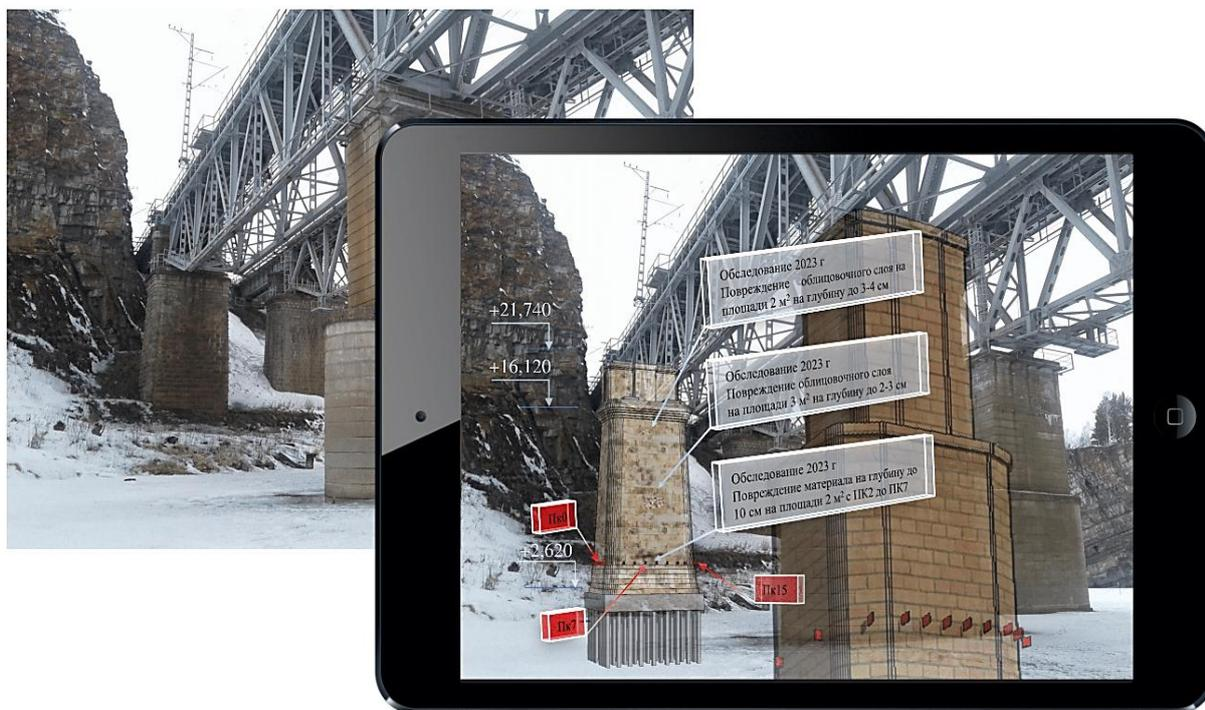
**Рис. 6. Пример возможного использования результатов цифрового проектирования и технологии дополненной реальности\* при последующем обследовании**
